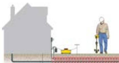
Прямое подключение к инженерным сетям.
