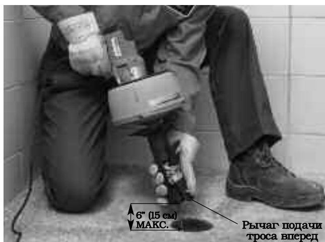
Рис. 10 – Автоматическая подача троса в режиме AUTOFEED
