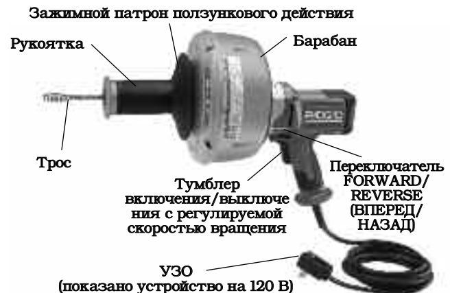
Рис. 1 – Инструмент для чистки канализации К-45 с зажимным патроном ползункового действия
