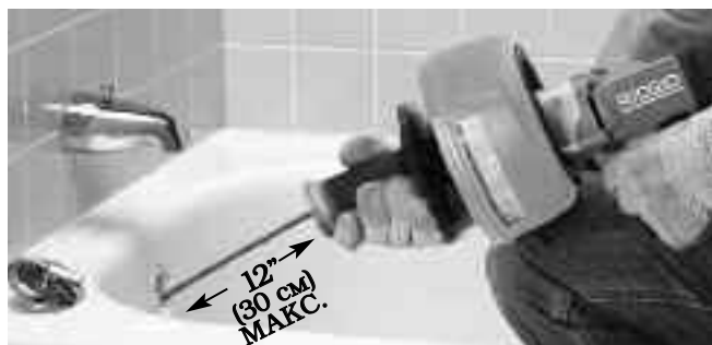
Рис. 8 – Переместите рукоятку в сторону к барабану, чтобы зажать трос зажимным патроном
