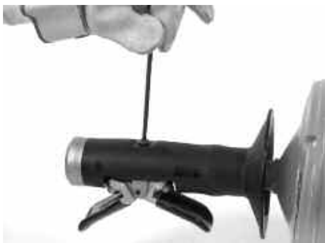
Рис. 12A – Отворачивание винта автоподачи AUTOFEED
