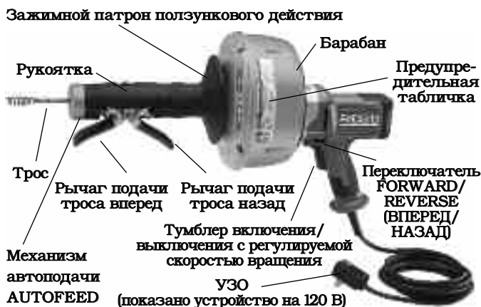
Рис. 2 – Инструмент для чистки канализации K-45 AF с автоподачей AUTOFEED
