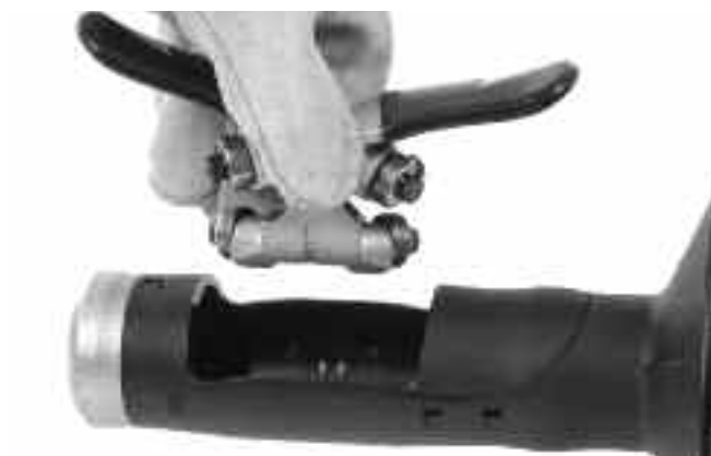
Рис. 12B – Снятие механизма автоподачи AUTOFEED с корпуса
