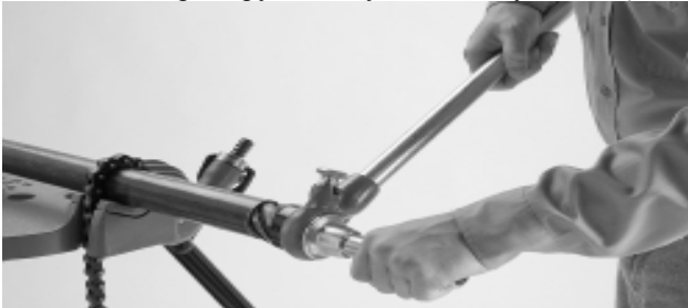
Рис. 2 – Зенкование края трубы.
