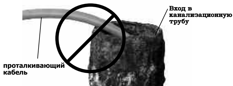
Рис. 23 – Не следует вытягивать кабель по острым кромкам
