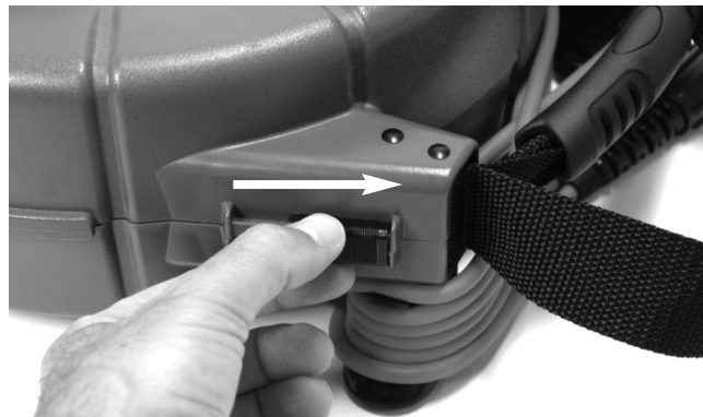
Рис. 4. Отстегивание корпуса барабана microDrain
