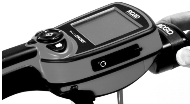
Рис. 10. Подключение инспекционной видеокамеры microEXPLORER
