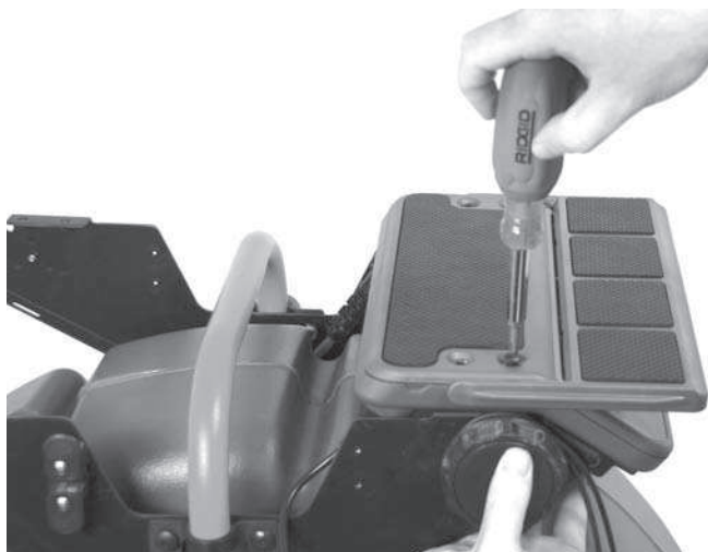
Рис. 13 – Установка правой платформы
