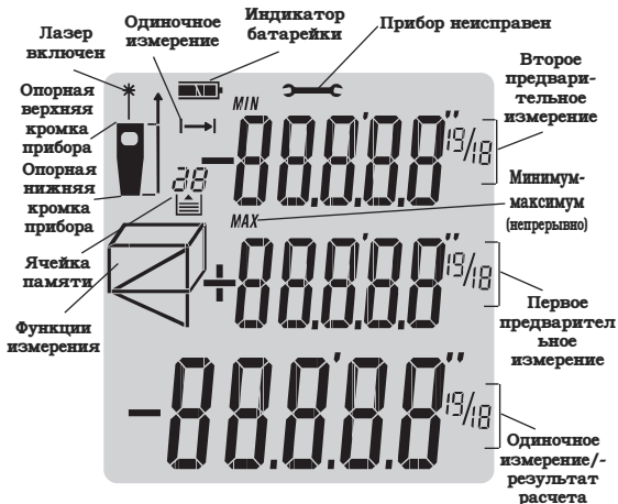
Рисунок 3 – ЖК дисплей прибора micro LM-100
